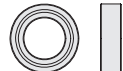
HBC8088 6x10mm Sealed Bearing Kugellager Gedichtet 6x10mm Joint étanche 6x10mm シールドベアリング 6x10mm
