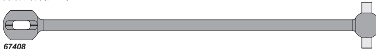
67408 Center Drive Shaft (105mm) Mittelkardan Welle (105mm/D8) Axe transmission central (105mm) センタードライブシャフト(105mm)
